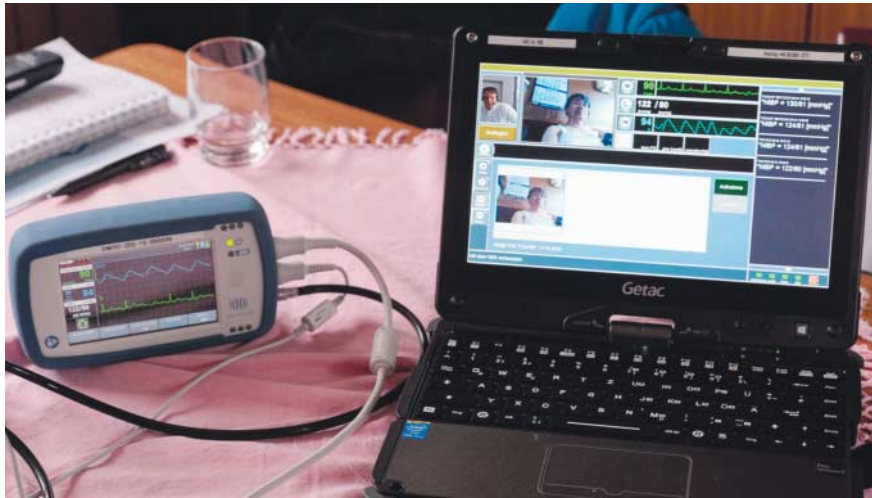
Das AescuLink-System besteht aus einem Ruggedized-Notebook mit Touchscreen und Videokonferenzfunktion sowie einem Diagnosemodul. Im Fenster links oben ist der zugeschaltete Arzt zu erkennen.
